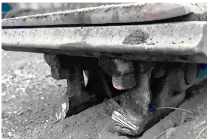
Рис. 7. Разрушенный трак Fig. 7. Destroyed track
