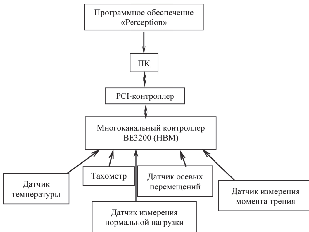
Рис. 4. Схема информационно-измерительной системы
