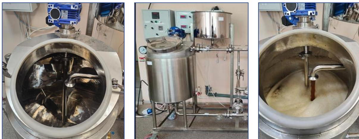
Рис. 2. Общий вид экспериментальной установки для исследования процесса СВЧ-экстракции
