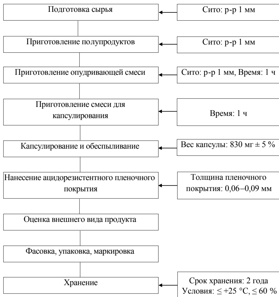
Технологическая схема производства БАД
