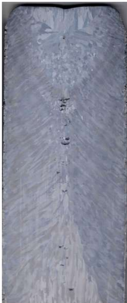
Рис. 1. Сравнение экспериментальных и расчетных профилей ванны (слиток А)
