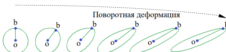
Рис. 2. Поворотная деформация в процессе РКУП по схеме простого сдвига
