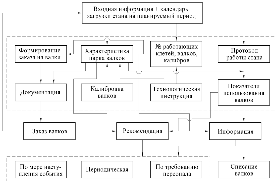
Рис. 2. Схема автоматизированной системы проектирования и управления валкового хозяйства прокатного стана
