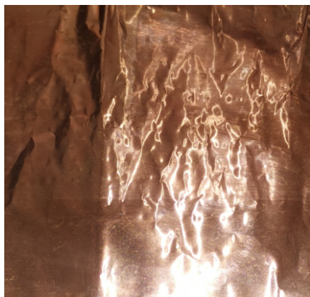
Рис. 1. Дефект «пузыри», двухсторонний гофр на поверхности ленты после прокатки Fig. 1. Defect “bubbles”, double-sided corrugation on the surface of the strip after rolling
