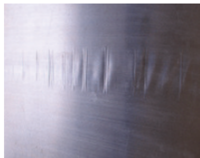
Рис. 3. Выпуклость валкового инструмента и текстура дефекта «корбоватость» Fig. 3. Convexity of the rolling tool and the texture of the defect – warpage
