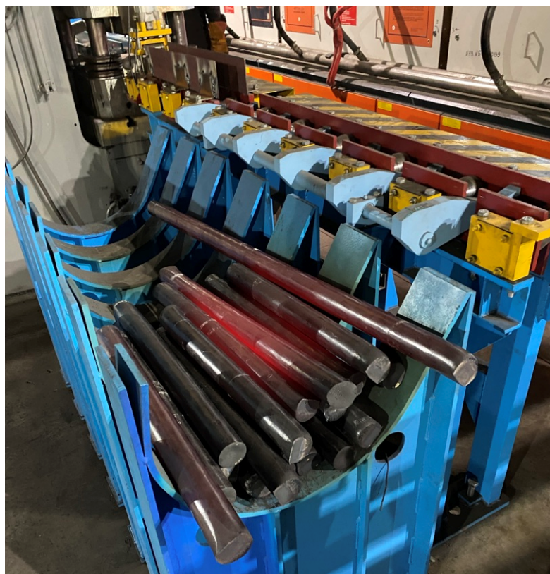
Рис. 5. Фрагмент участка с поковками в кармане-накопителе после их резки Fig. 5. Fragment of a section with forgings in a storage pocket after cutting them
