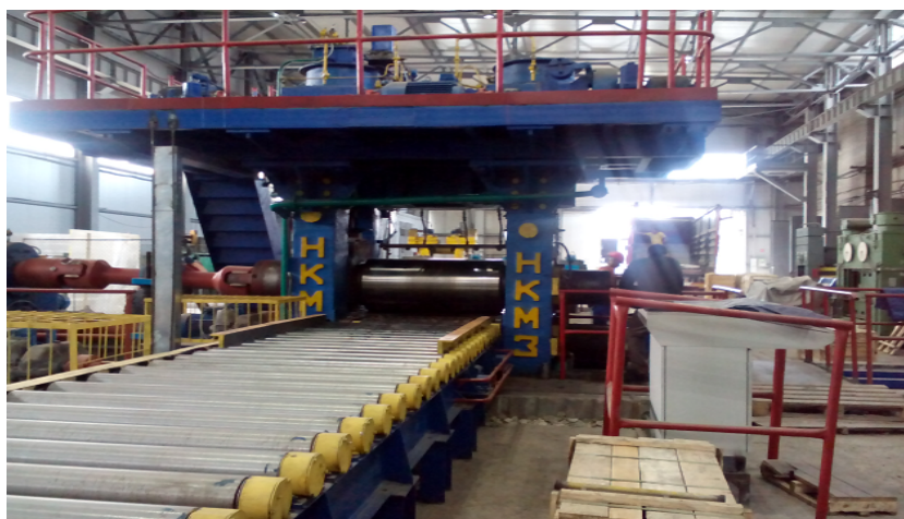
Рис. 1. Стан двухвалковый 710 × 1400 мм ООО НПО «Р.О.С.Антикор» Fig. 1. Twin-roll mill 710 × 1400 mm RPA “R.O.S.Anticor” LLC
