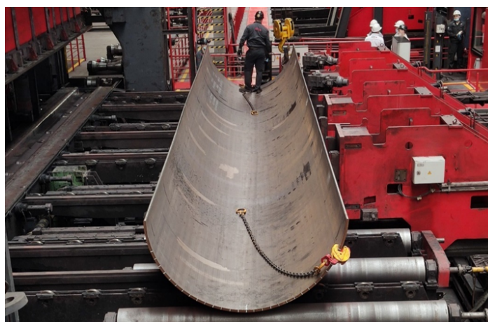
Рис. 9. Выдача заготовки рабочего пространства прессы Fig. 9. Issuance of blanks from the press working space
