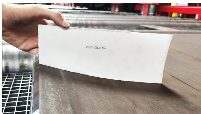
Рис. 8. Контроль геометрии подогнутой кромки Fig. 8. Control of the geometry of the folded edge
