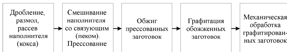
Рис. 4. Технологическая схема получения изделий на ЧЭЗ [1]
