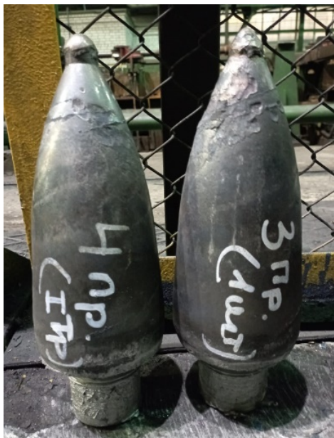
Рис. 8. Оправки после прошивки третьей и четвертой заготовок для трубы 140 × 21,5 из нержавеющей стали Fig. 8. Mandrels after flashing the third and fourth blanks for a 140 × 21.5 stainless steel pipe
