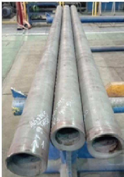
Рис. 9. Внешний вид и внутренний винт на трубах 168 × 28 мм Fig. 9. Appearance and internal screw on pipes 168 × 28 mm
