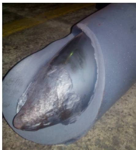
Рис. 6. «Закат» оправки в заднем конце гильзы из-за сваривания материала оправки с прошиваемой заготовкой Fig. 6. “Rolling” of the mandrel at the rear end of the liner due to welding of the mandrel material with the workpiece being stitched
