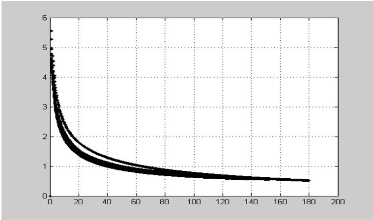
Рис. 4. Зависимость величины возмущений от расстояния до источника
