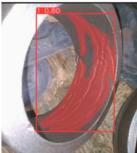
Рис. 8. Распознавание дефектов с помощью нейросети № 2 Fig. 8. Defect recognition with the help of neural network No. 2
