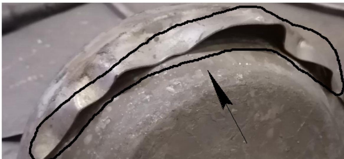
Рис. 2. Дефект «заусенец» Fig. 2. The “burr” defect
