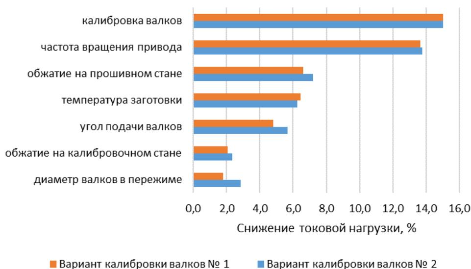
**Рис. 1. Зависимость токовых нагрузок на привод трехвалкового стана винтовой прокатки при обжати заготовок от изменения различных технологических параметров процессов прокатки на условную единицу**
