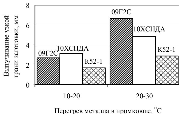
Рис. 3. Влияние перегрева металла в проковше на выпучивание узкой грани слывовой заготовки толщиной 270 мм
