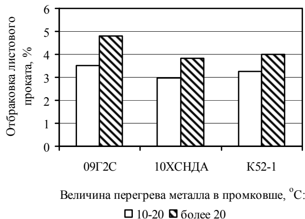
Рис. 2. Отбраковка листового проката из слывовой заготовки 270×1200 мм, отлитой при разном уровне перегрева металла в проковше
