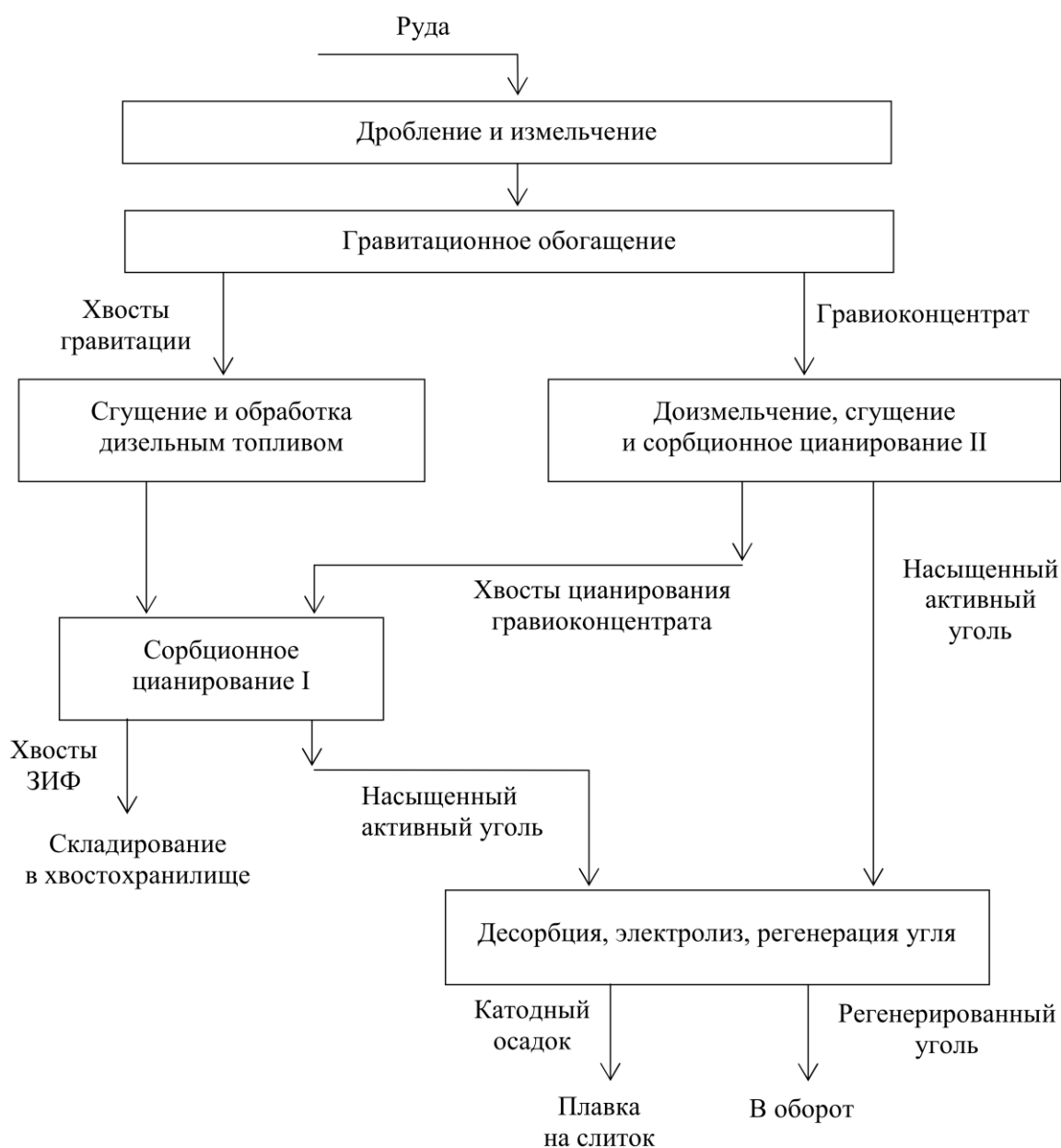
Рис. 1. Принципиальная схема гравитационно-цианистой технологии переработки высокосорбционно-активной руды, заложенная в технологический регламент Fig. 1. Schematic diagram of the gravitational cyanide technology for processing highly sorption-active ore, incorporated into the technological regulations
