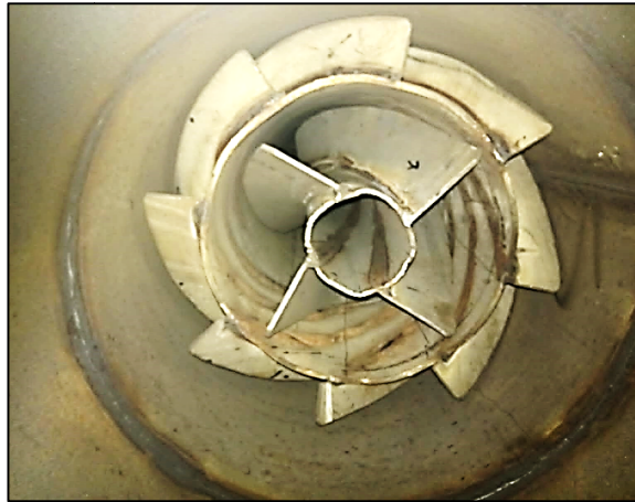
Рис. 3. Завихрители воздушных потоков со стороны наконечника фурмы Fig. 3. Air flow swirls from the tuyere tip side
