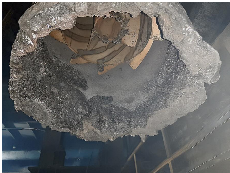
Рис. 4. Типовой вид наличия расплава на внутренней поверхности наконечника и устье фурмы при его износе до величины менее 350 мм и соответствующей крутке выше 1,4
