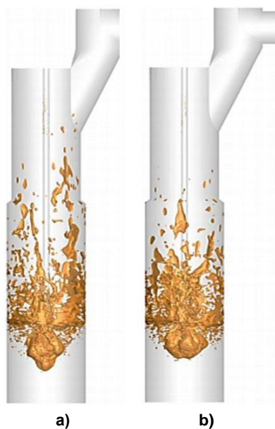
Рис. 2. Качественная оценка многофазового потока в печи: а – без завихрителя; б – с завихрителем [11]
