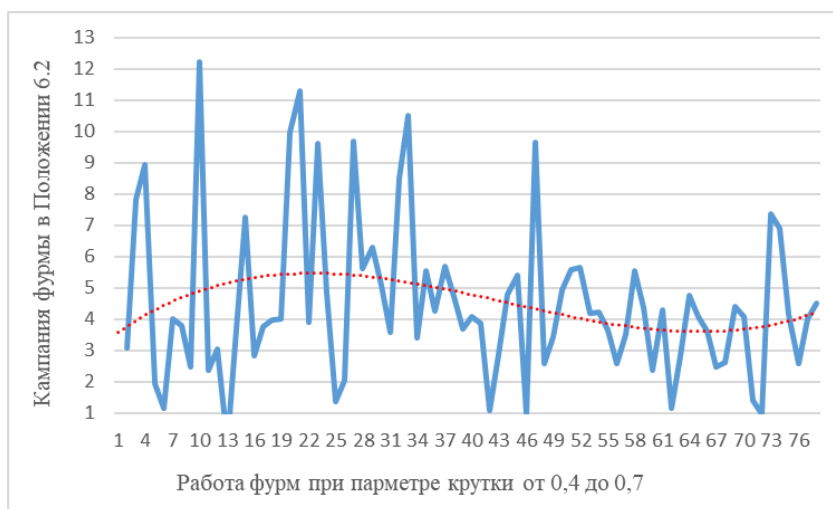
Рис. 12. График кампании фурм за период с 04.2024 г. по 08.2025 г., работающих в оптимальном режиме f , равном 0,4–0,7, с линейной линией тренда изменения кампании их работы Fig. 12. Graph for the tuyere campaigns for the period from April 2024 to August 2025, operating in optimal mode f equal to 0.4 to 0.7, with a linear trend line showing changes in their operation
