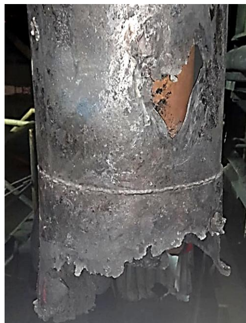
Рис. 9. Обгорание наконечника и прогар тела фурмы Fig. 9. Burning of the tip and burnout of the tuyere body
