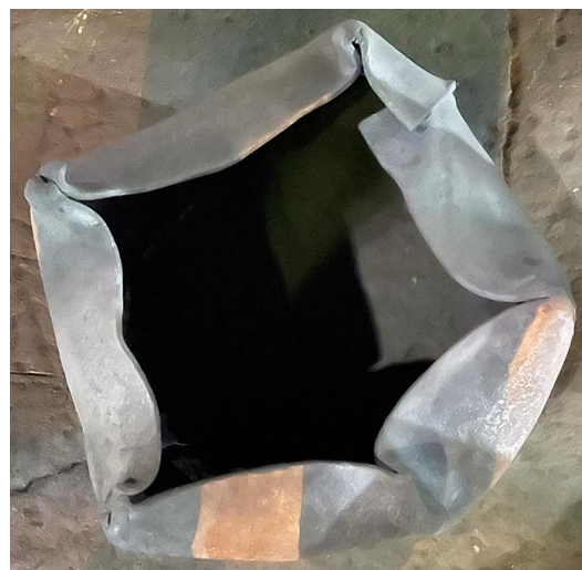
Рис. 2. Заклёпывание наконечника фурмы Fig. 2. Rolling over of the tuyere tip
