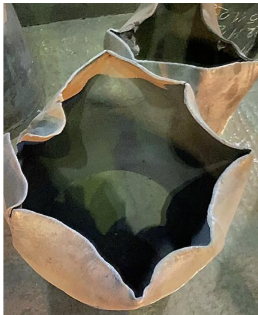
Рис. 3. Завальцовывание наконечника фурмы с разрывом Fig. 3. Rolling over of the tuyere tip with a break
