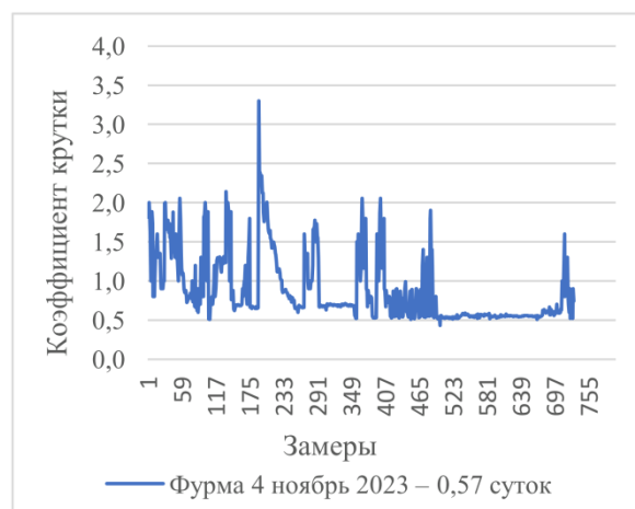
Рис. 4. Изменение крутки при завальцовывании наконечника Fig. 4. Twist change when the tip is rolled over
