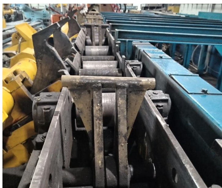
Рис. 6. Вид на видимые элементы клапанного сбрасывателя в поднятом положении с рольгангом и склизом Fig. 6. View of the visible elements of the valve ejector in the raised position with a roller table and a slide
