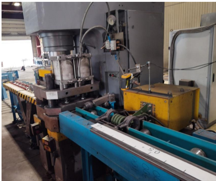
Рис. 7. Вид на участок поперечной резки со стороны подачи заготовок к режущему штампу
