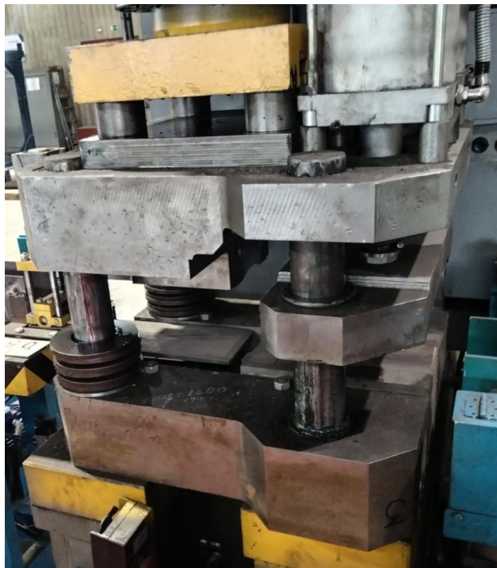
Рис. 9. Вид на штамп поперечной резки заготовок с пневматическим прижимом и пружинными амортизаторами, установленный на гидравлическом прессе усилием 1600 кН Fig. 9. View of the cross-cutting die with pneumatic clamp and spring shock absorbers, mounted on a hydraulic press with a force of 1600 kN
