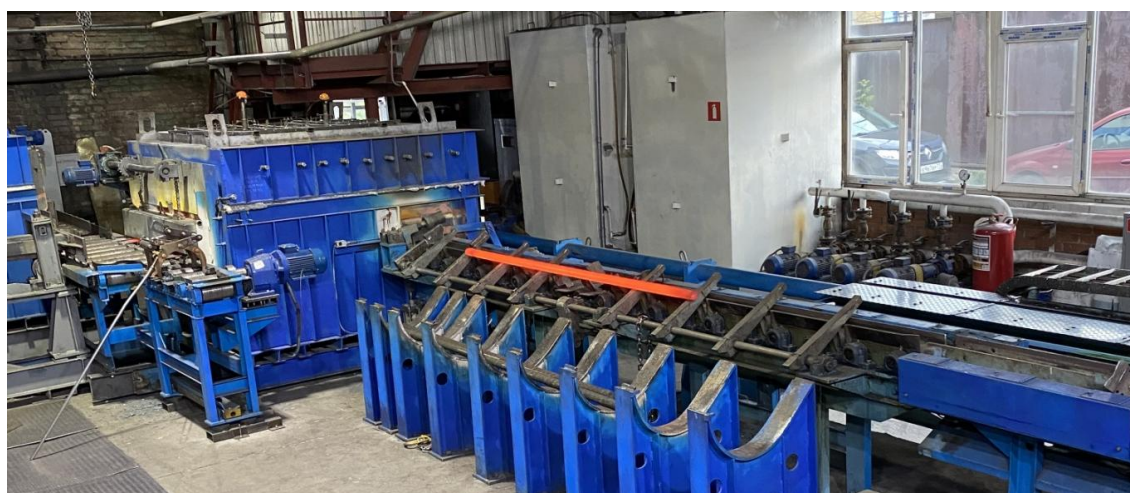
Рис. 5. Вид на методические печи, накопительные карманы, сбрасыватель Fig. 5. View of the continuous furnaces, storage pockets, and discharge device
