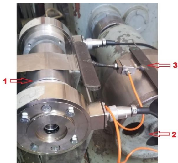
Рис. 5. Тарировка датчиков измерения силы натяжения при прокатке: 1 – натяжной ролик с тензометрическими опорами; 2 – моталка; 3 – тензометрический датчик силы при растяжении
