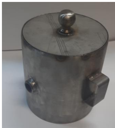
Рис. 8. Сосуд для отжига нитиноловой ленты в защитной атмосфере
