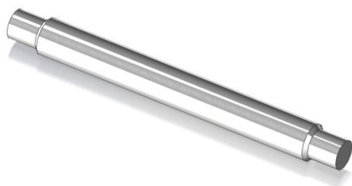
Рис. 4. Трехмерная модель детали «Валок» Fig. 4. Three-dimensional model of the “Roller” part
