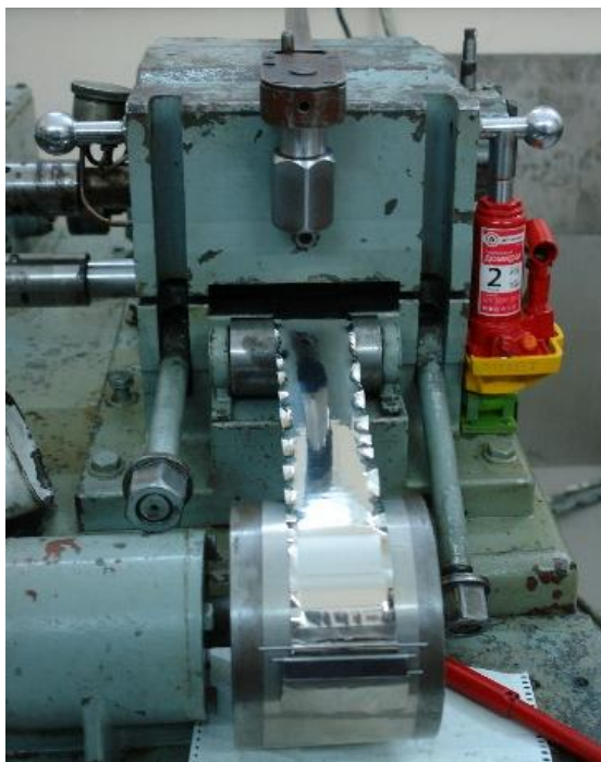
Рис. 3. Вид сбоку станины двадцативалкового прокатного стана 12/160 (до модернизации) Fig. 3. Side view of the frame of a twenty-high rolling mill 12/160 (before modernization)
