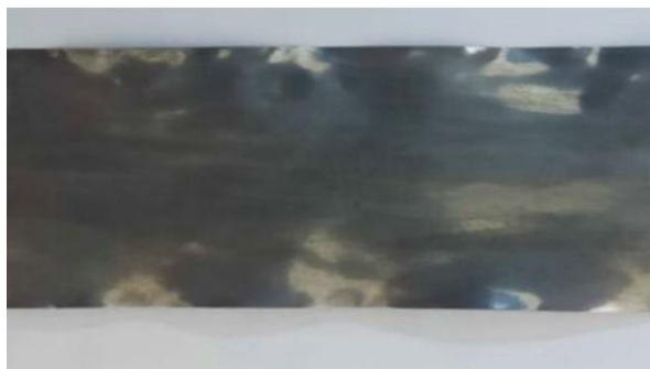
Рис. 9. Прокатанная нитиноловая лента толщиной 39 мкм Fig. 9. Rolled nitinol tape with a thickness of 39 μm
