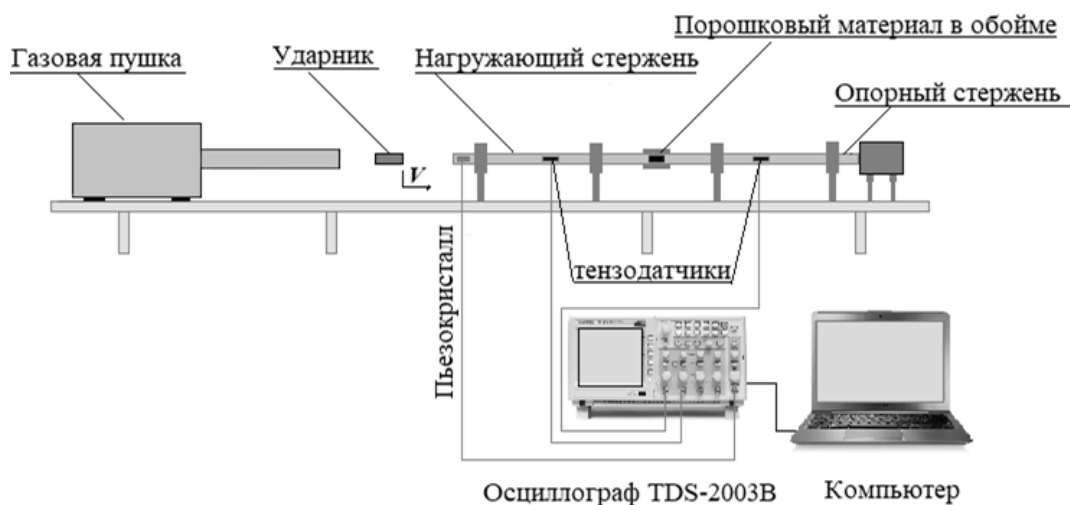
Рис. 2. Схема экспериментальной установки для импульсного прессования порошковых материалов Fig. 2. Schematic diagram of the experimental setup for pulse pressing of powder materials
