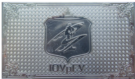
Рис. 4. Изделие после никелирования Fig. 4. Products after nickel plating
