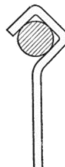
Рис. 2. Катодный крюк правильной формы Fig. 2. Cathode hook of the correct shape
