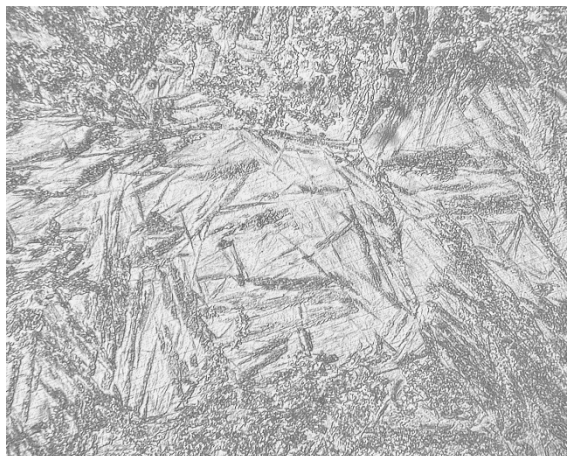
Рис. 1. Микроструктура образца от труб из стали 38ХН3МФА в горячедеформированном состоянии, \times 1000 Fig. 1. Microstructure of a sample of 38KhN3MFA steel pipes in a hot-deformed state, \times 1000
