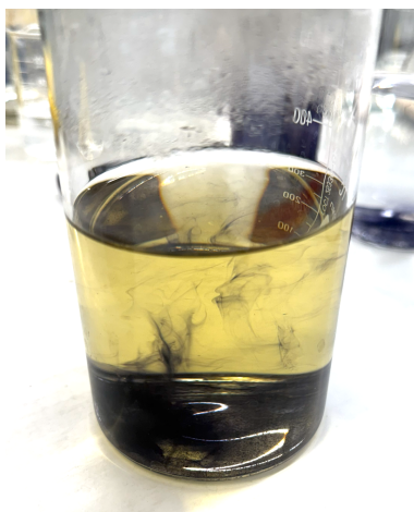
Рис. 6. Выделение молекулярного йода при разложении KI при добавлении крахмала после введения стержня в раствор Fig. 6. Generating molecular iodine when KI decomposes with adding starch after putting the rod inside the solution
