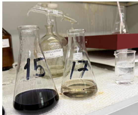
Рис. 2. Цвет KI через 20 мин в колбах № 15 и 17 Fig. 2. KI colour after 20 min in flasks No. 15 and 17
