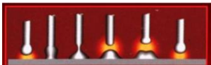
Рис. 1. Перенос капли электродного металла при сварке на постоянном токе с короткими замыканиями дугового промежутка [4]
