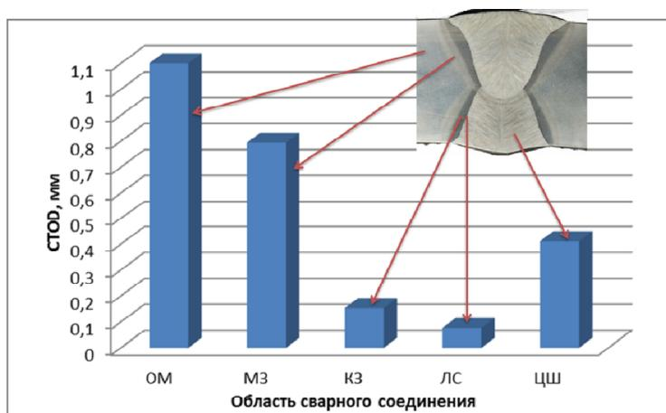
Рис. 1. Механическая неоднородность сварных соединений труб большого диаметра
