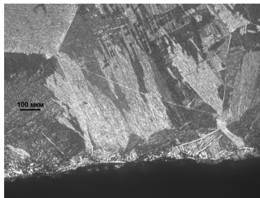
Рис. 16. Микроструктура поверхности контакта сплава с формой (связующее ЕНТ 5 % АСД)
