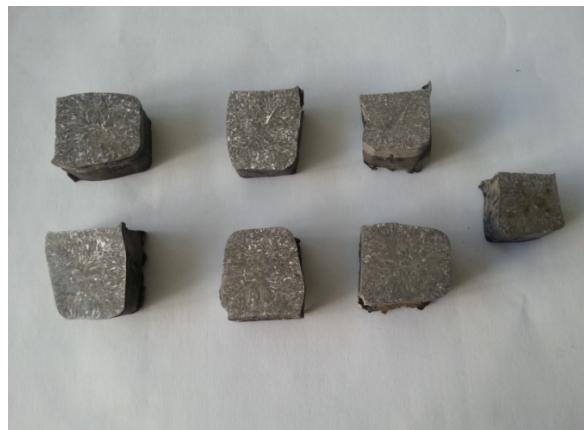
Рис. 11. Образцы отливки для исследования на наличие альфированного слоя
