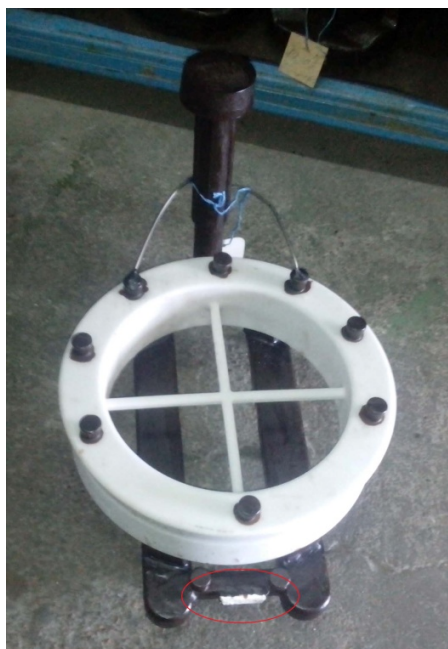
Рис. 10. Модельный блок с образцами керамической формы на основе кремнезелей
