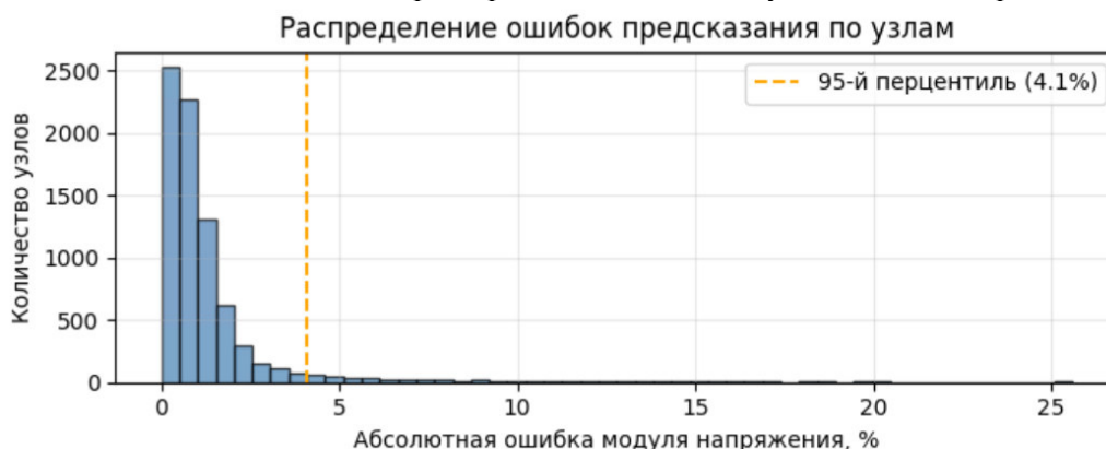
Рис. 3. Распределение абсолютной ошибки предсказания модуля напряжения по узлам сети
