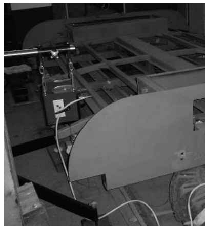
Рис. 4. Возбуждение колебаний каркаса крыши с использованием модального вибростенда
