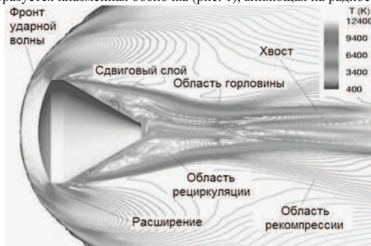
Рис.1. Структура плазменной оболочки объекта, движущегося в атмосфере с гиперзвуковой скоростью.
