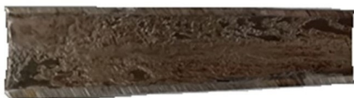
Рис. 12. Фото внутренней поверхности разрезанной трубки после электрохимического износа
