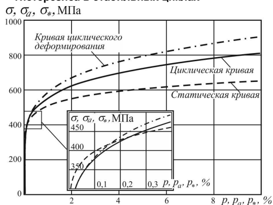
Рис. 4. Сопоставление кривой циклического деформирования, циклической и статической кривых стали А606-4
