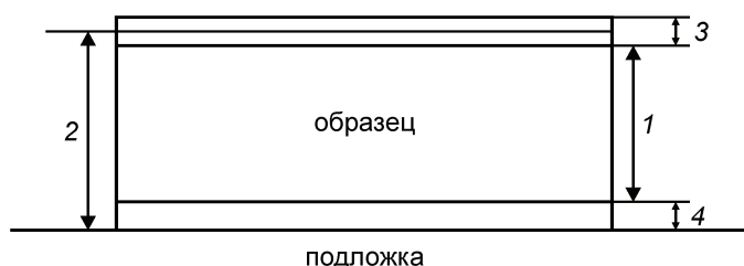
Рис. 5. 1 – Реальная толщина образца, 2 – толщина, рассчитанная по МСЭ, 3 – внешний оксидный слой, 4 – переходный слой
