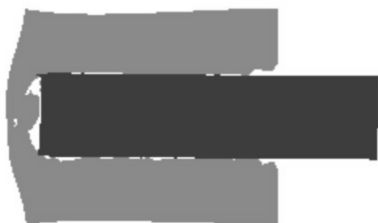
Рис. 7. Максимальное внедрение ударника в элемент из алюминиевого сплава Д16Т при начальной скорости ударника 900 м/с
