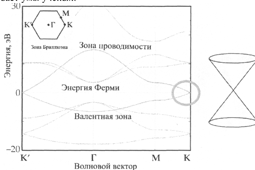
Рис. 2. Зона Бриллюэна и закон дисперсии для графена
