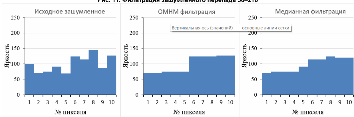
Рис. 12. Фильтрация зашумленного перепада 80–120
