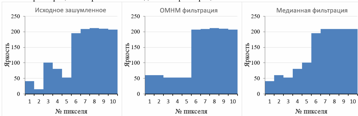
Рис. 11. Фильтрация зашумленного перепада 50–210
