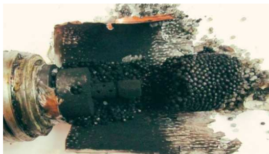
Рис. 2. Результат введения электроразрядной плазмы в гранулированный полиэтилен
