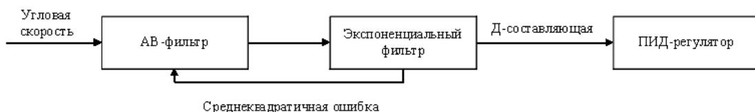
Структурная схема метода адаптивной фильтрации при формировании Д-составляющей ПИД-регулятора
