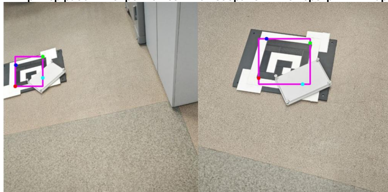
Рис. 13. Пример работы нейронной сети на изображениях с перекрытым маркером
