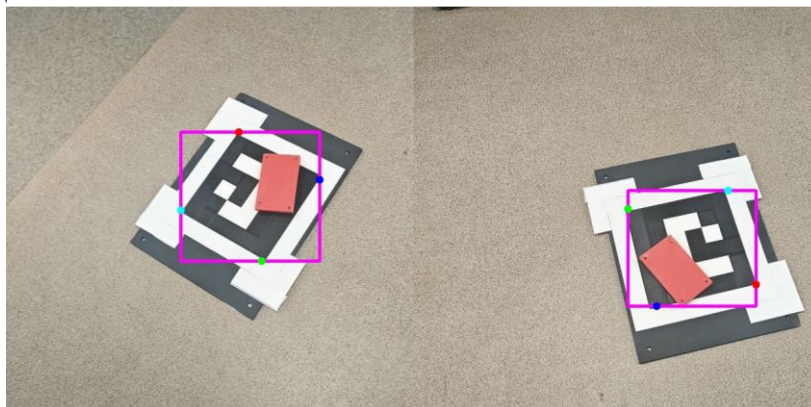
Рис. 12. Пример работы нейронной сети на изображениях с перекрытым маркером
