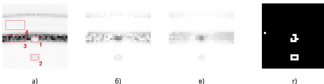
Рис. 3. Участок изображения стеклянной детали изолятора ПС-70Е с дефектом: а) исходного, б) после частотной фильтрации, в) после шумоподавления, г) после обнаружения границ
