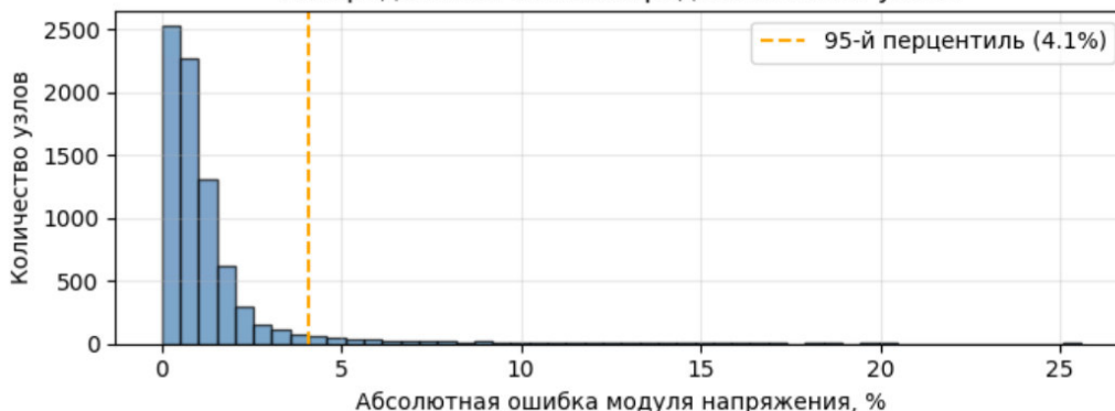
Рис. 3. Распределение абсолютной ошибки предсказания модуля напряжения по узлам сети
